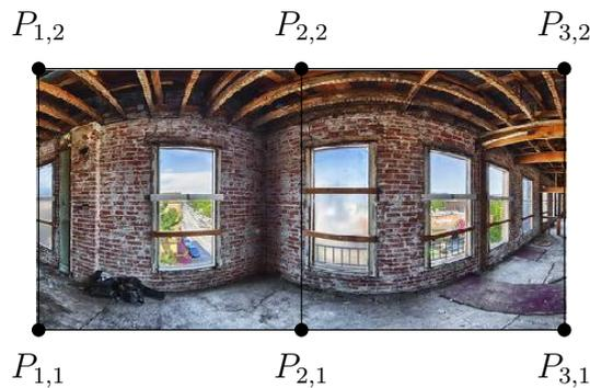
Figura 3.1.6 – Exemplo de como os pontos são distribuídos na malha discretizada. Nesse caso temos `lambda_min=-2`, `lambda_max=2`, `phi_min=-1`, `phi_max=1`, `m=1` e `n=2`.
