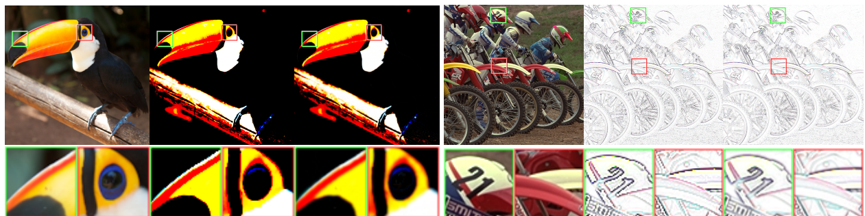
Figura 3: Tucanos: 1 - Imagem Original; 2 - Processou a imagem original com um ajuste de tons de cinza; 3 - Aplicou-se R(u, v) com Gaussiano com D0 = 0,3 e k = 0 . Motoqueiros: 1 - Imagem Original; 2 - Processou a imagem original com o filtro laplaciano normalizado; 3 - Aplicou-se R(u, v) com Gaussiano com D0 = 0,4 e k = 0,013245
